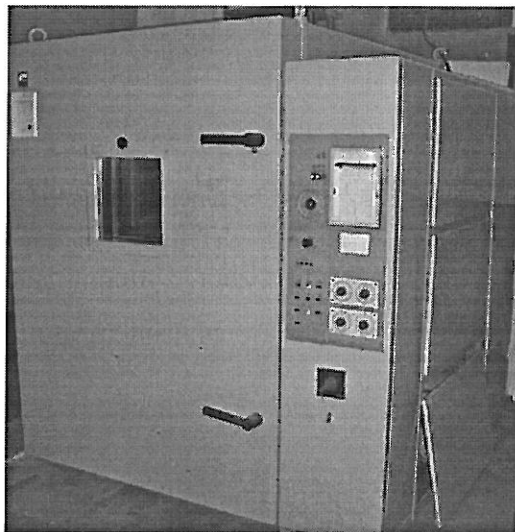
Рисунок 1 – Кліматична камера для проведення циклічних кліматичних випробувань
