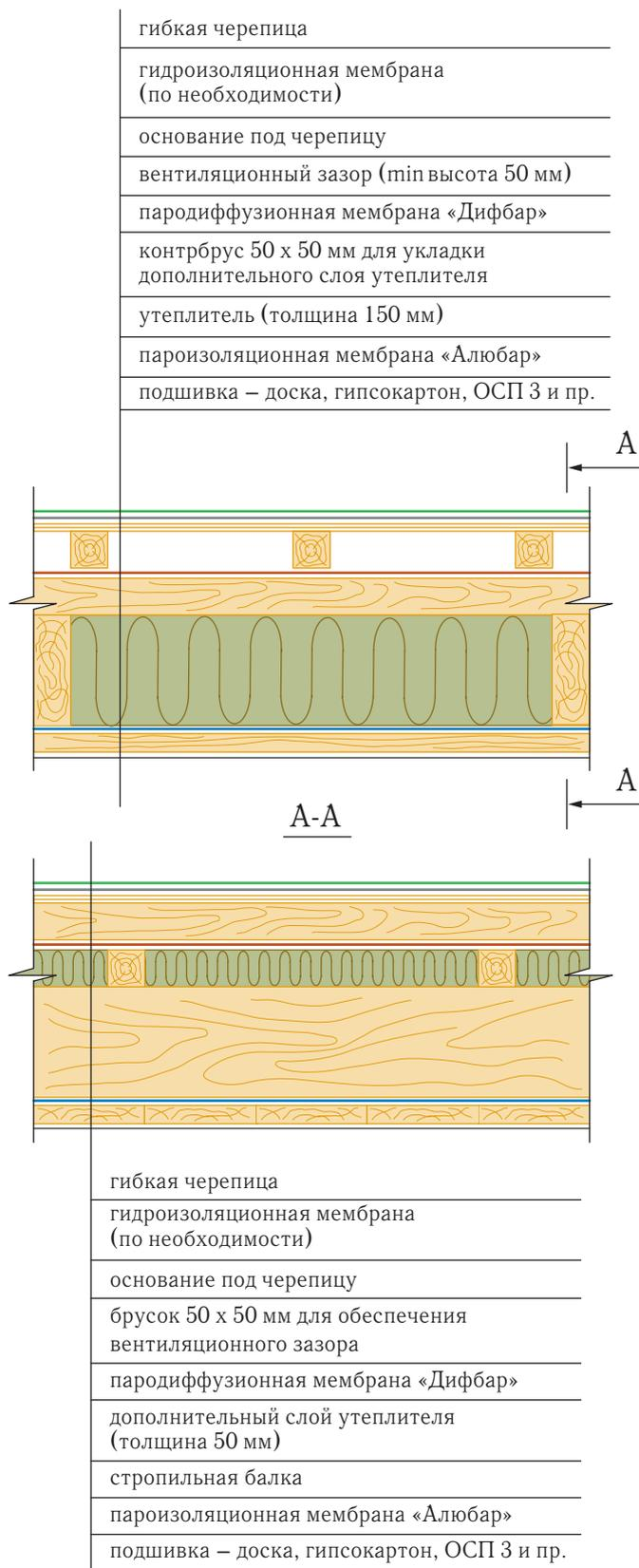
Рис. 4.3.2. Конструкция традиционной крыши мансарды
