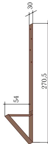
**Примечание:** крепежное отверстие и шляпку гвоздя / самореза рекомендуется загерметизировать битумной мастикой.
