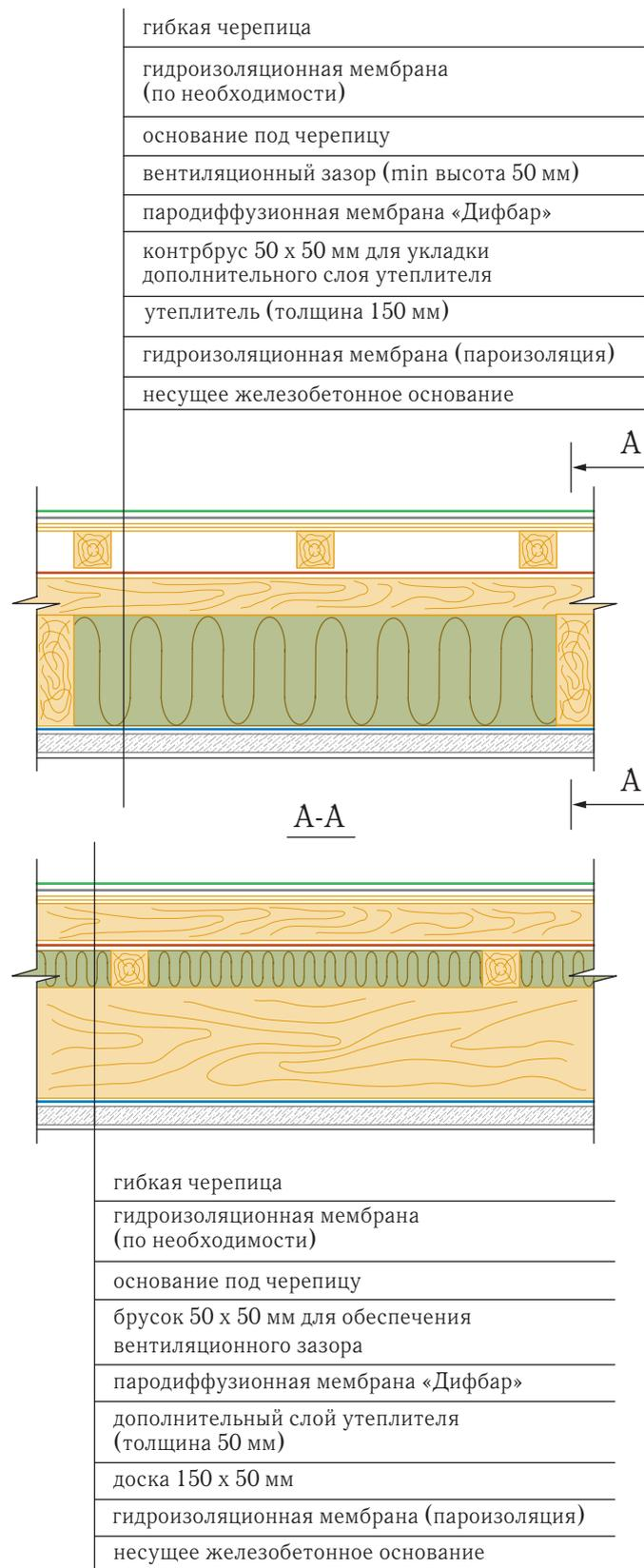
Рис. 4.5.2. Крыша по железобетонному основанию
