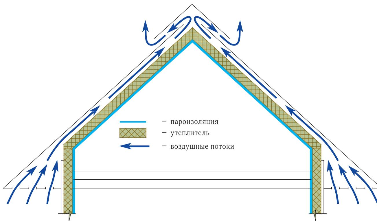
Рис. 3.2. Схема утепления, пароизоляции и вентиляции мансарды
