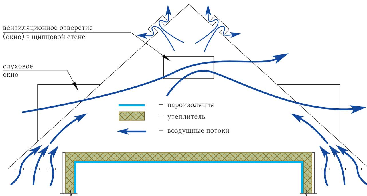
Рис. 3.1. Схема утепления, пароизоляции и вентиляции нежилого чердачного помещения
