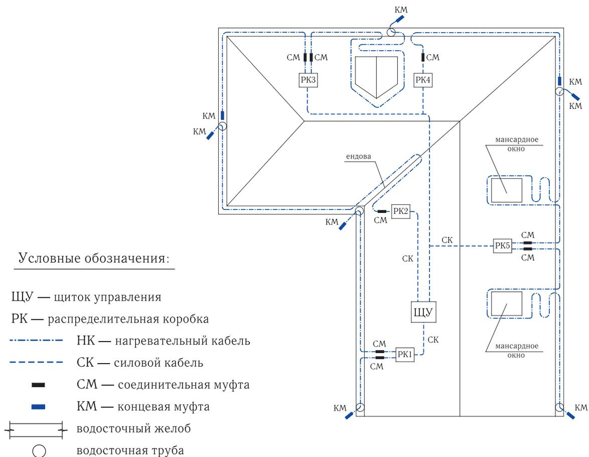
*Рис. 3.5. Кабельная система обогрева кровли.
