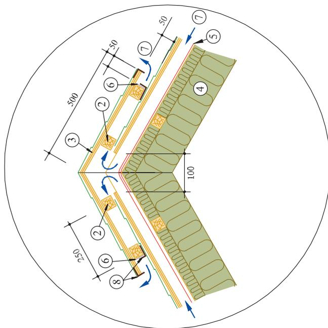
**Примечания:** 1. На торцы («фронтоны») вентиляционного конька рекомендуется устанавливать металлический фронтонный фартук S5, развертка 20 см;
